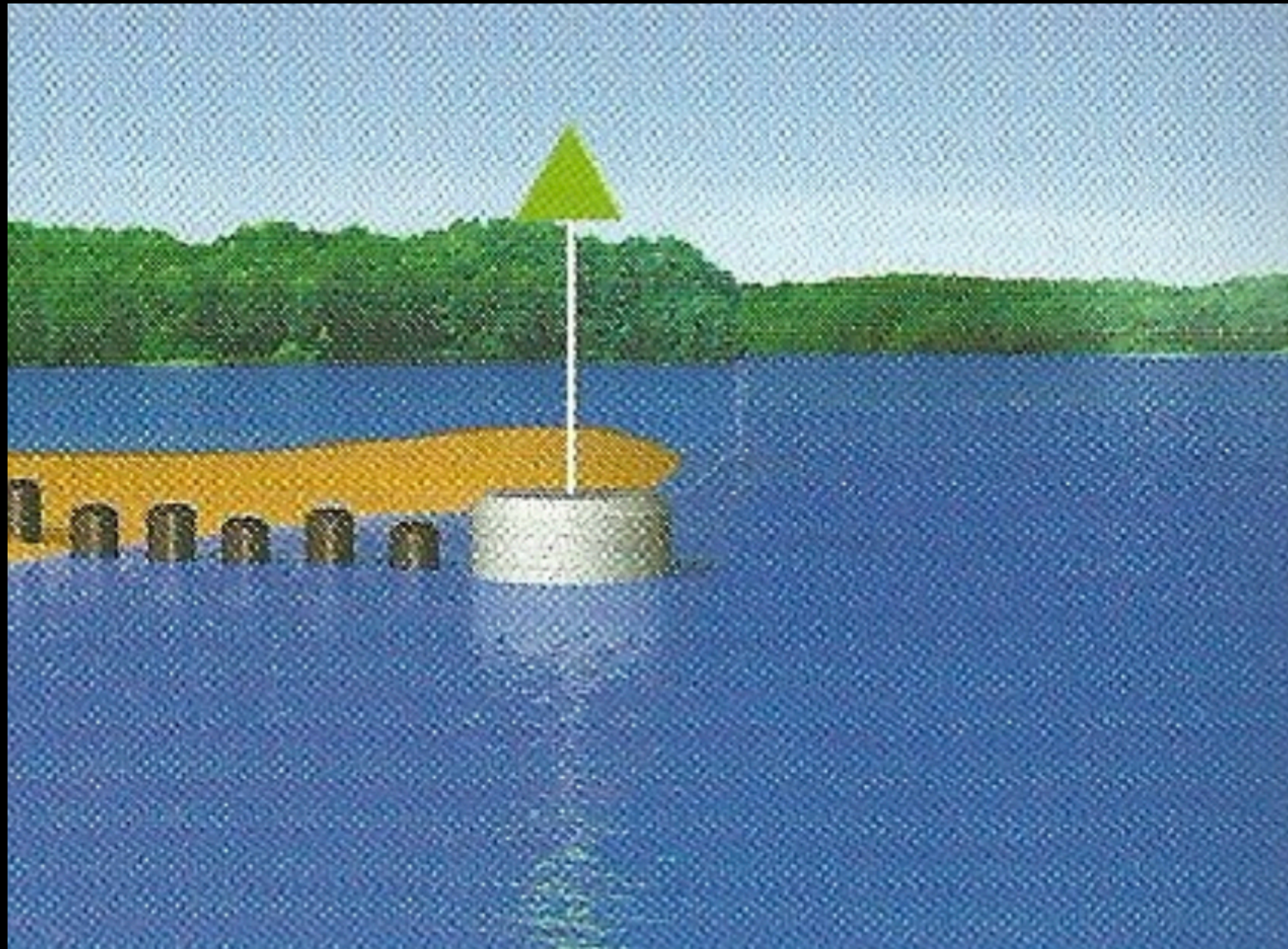
Znak stały na lewym brzegu - miejsce niebezpieczne, przeszkoda żeglugowa
